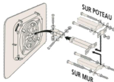
Fixation universelle en acier galvanisé pour murs et poteaux de 60 à 90 mm de section. Permet un réglage très précis de la position du miroir. Testée pour résister au vent jusqu'à 183 km/h.
