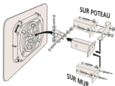
Fixation universelle en acier galvanisé pour murs et poteaux de 60 à 90 mm de section. Permet un réglage très précis de la position du miroir. Testée pour résister au vent jusqu'à 183 km/h.
